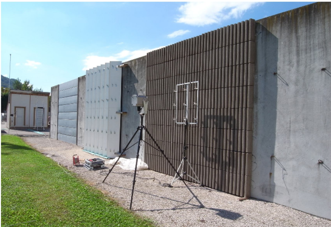
Foto: Nuevos métodos de ensayo para la caracterización de pantallas acústicas in situ.
